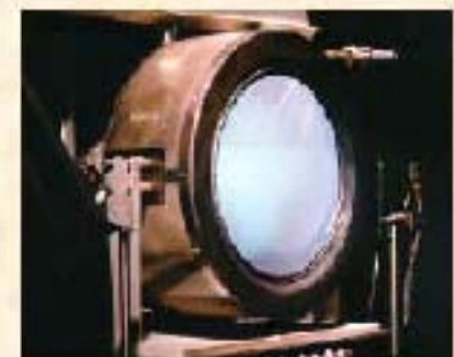
Ionique à grilles 2,3 kW (NASA/Boeing, U)
